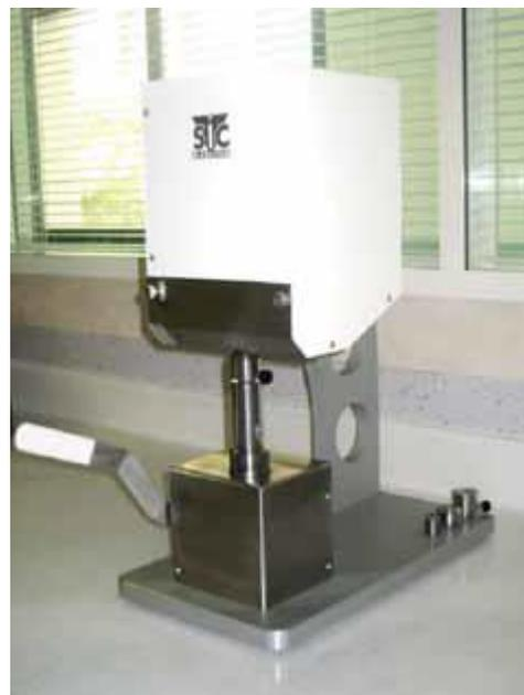
**Figure 13** Un automate à marquage par micro-percussion [6]
