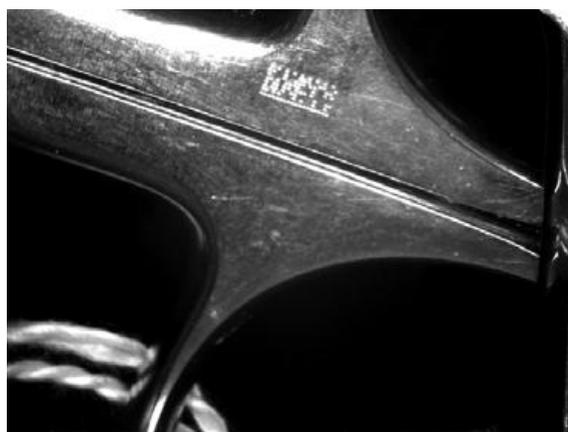
**Figure 27** Le marquage par micro-percussion offert par NBAutomation [39]
