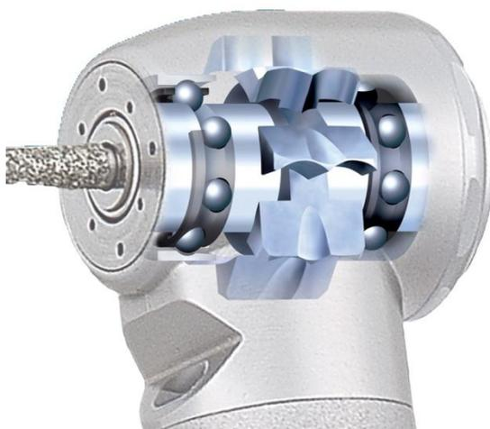
**Figure 2** Paliers à roulement intégré d'une turbine NSK (les petits trous sur la tête autour de la fraise correspondent aux jets d'eau et à la lumière) [9]
