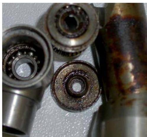
**Figure 8** Mécanismes internes ayant subi une corrosion [2]
