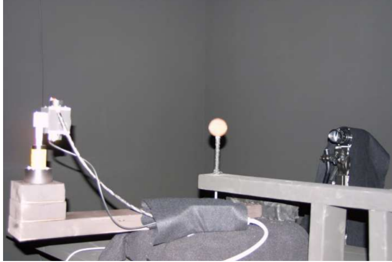
FIGURE 2.3. Le gonioréfectomètre de Matusik et al. [44].
