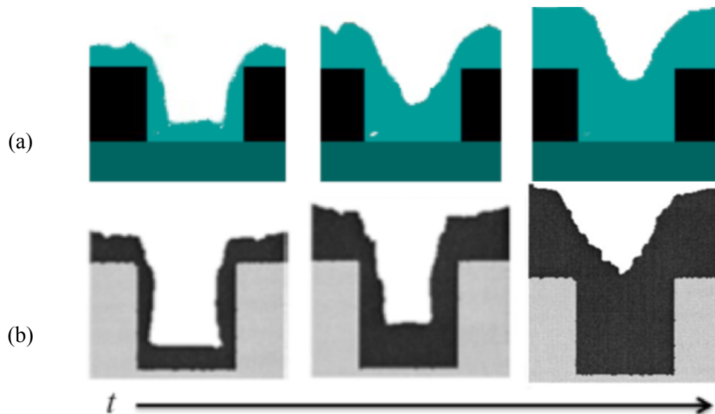
Figure 67. Comparaison entre a) la simulation du profil de dépôt de vapeur de platine assisté par bombardement ionique et b) résultats de simulation du dépôt de cuivre assisté par bombardement ionique [193].
