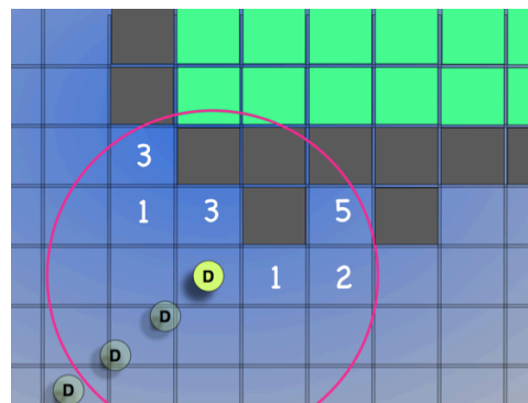
Figure 46. Vue schématisée du calcul du nombre de voisins lors du dépôt d'adatoms.
