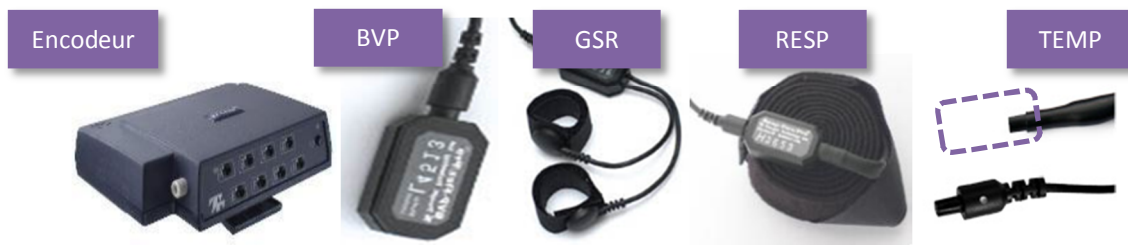
Figure 2.9 – Matériel physiologique utilisé pour enregistrer les émotions. De gauche à droite : encodeur, capteur BVP, capteur GSR, capteur RESP, capteur TEMP.
