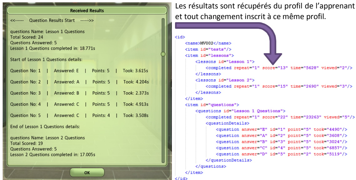
Figure 8.9 – Sauvegarde des résultats sur le serveur et leur affichage dans l'interface
