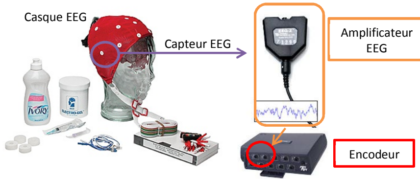
Figure 5.3 – Matériel physiologique utilisé pour enregistrer les ondes cérébrales
