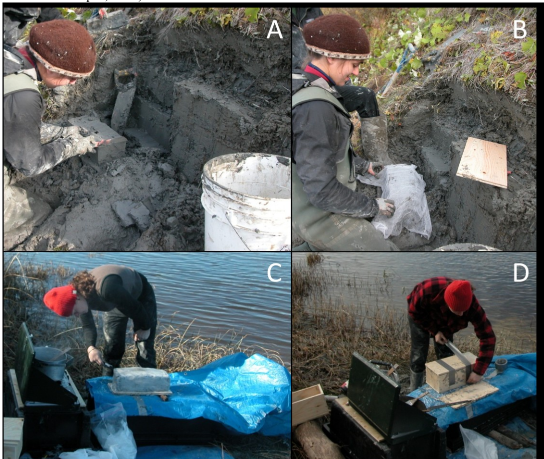
Figure 2.4 Étapes de la cueillette des échantillons : A. Coupe de l'échantillon; B. Enrobage avec du coton fromage; C. Scellage avec la paraffine; D. Immobilisation de l'échantillon dans une boîte de bois (Photos : Geneviève Marquis, 2010).
