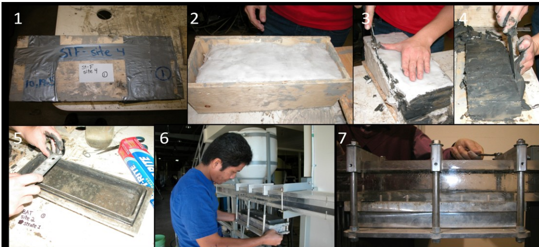
Figure 2.8 Étapes de préparation de l'échantillon avant l'expérience en chenal expérimental : 1 : Identification de l'échantillon, 2 et 3 : Retrait de la paraffine, 4 et 5 : Taillage de l'échantillon selon les dimensions exactes de la boîte d'échantillon, 6 et 7 : Installation de l'échantillon sur le chenal expérimental (Photos : Michèle Tremblay et Tommy Sutarto, 2010).
