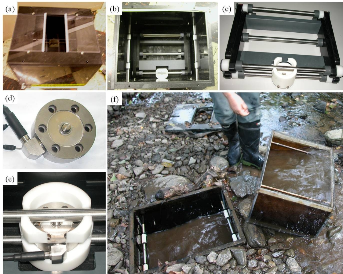
Figure 1.7 Photos des diverses composantes des boîtes à sédiments installées au ruisseau Béard. (a) Extérieur de la boîte avec le couvercle. (B) Intérieur de la boîte sans le couvercle et sans le boîtier interne. (c) Appareil de répartition du poids qui s'insère au fond de la boîte à sédiments. (d) La cellule de charge. (e) La cellule de charge dans son compartiment permettant la répartition du poids. (f) La boîte à sédiments de la section aval. Notez que le boîtier interne amovible est accessible lorsque le couvercle est retiré.
