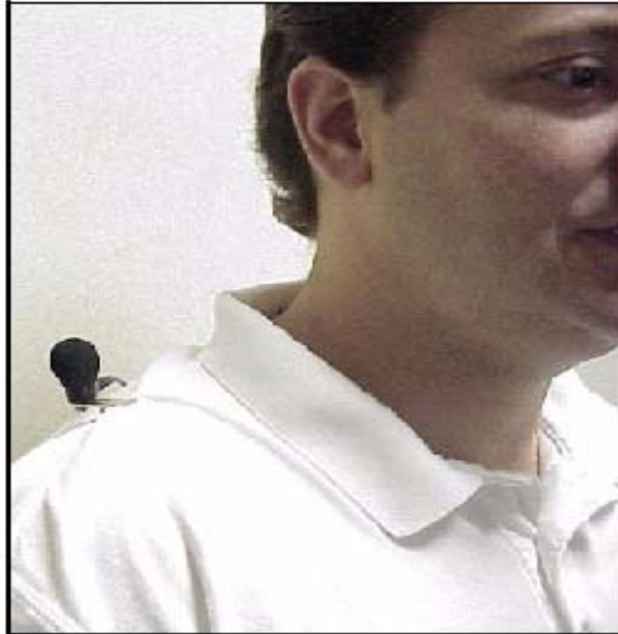
Figure 12 : Positionnement du microphone relié au dosimètre.
