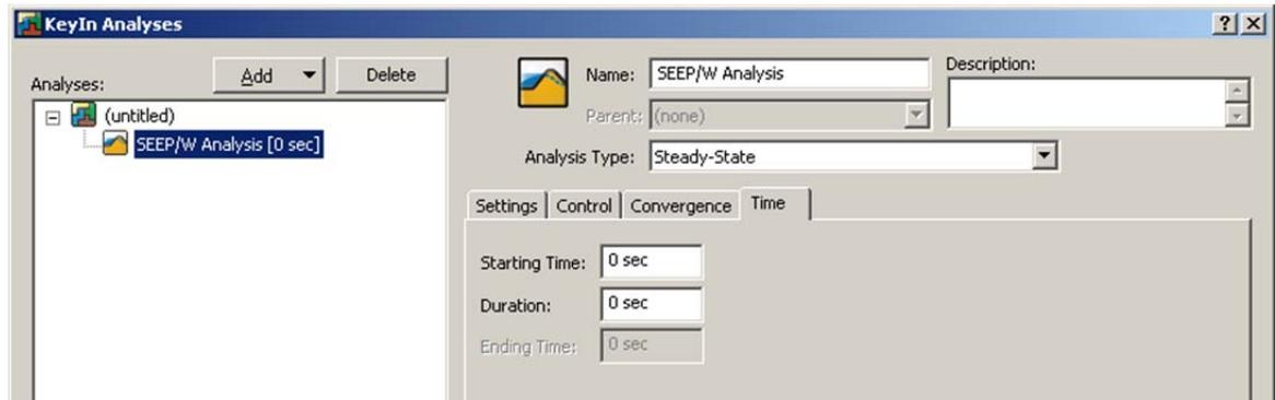
Figure A5. Établissement des paramètres de temps (onglet *Time*)
