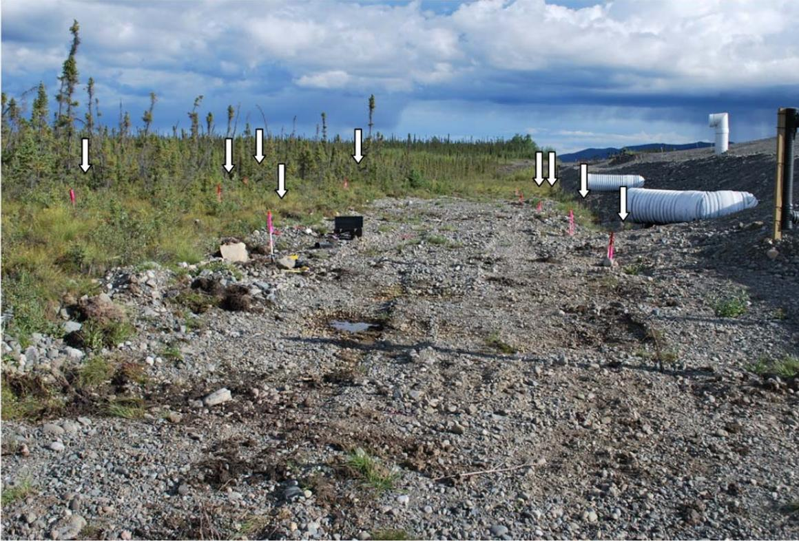
**Figure 7. Réseau de puits d'observation (bâtons sous les flèches) du côté amont (nord-est) de la route.**
