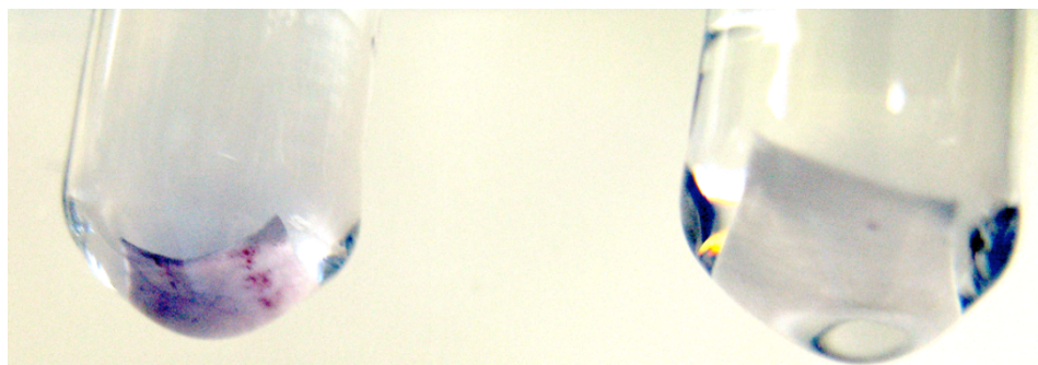
Figure 32. Test de Kaiser pour papier couché avec microcapsules (à gauche) et sans microcapsules (à droite). Microcapsules couchées à l'aide du CLC.
