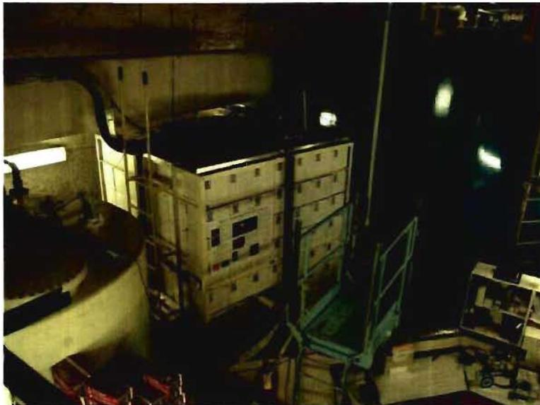
Figure 3.6 – Vue de l'ensemble du détecteur PICASSO couvert de son blindage de cubes d'eau. Le système de régulation et de distribution du courant est situé sur le sommet du détecteur.
