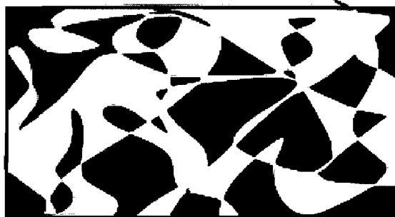
Figure 4.1 – Schéma d'une hétérojonction distribuée dans le volume, le vert et le blanc représentent les phases de deux polymères distincts.
