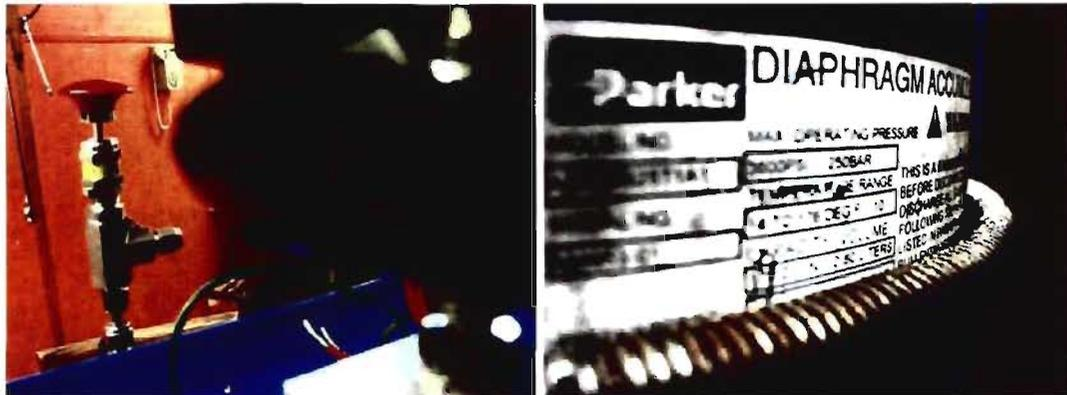
(a) Soupape de décharge située avant le régulateur électronique
