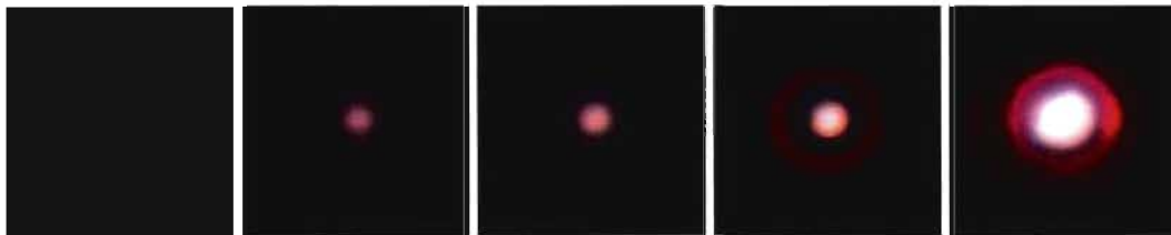
Figure 3.8 – Modes de la lumière blanche générée dans du \text{CaF}_2 en fonction de la puissance incidente (les puissances sont dans l'ordre : 1 mW, 1,4 mW, 1,6 mW, 2 mW et 3 mW).
