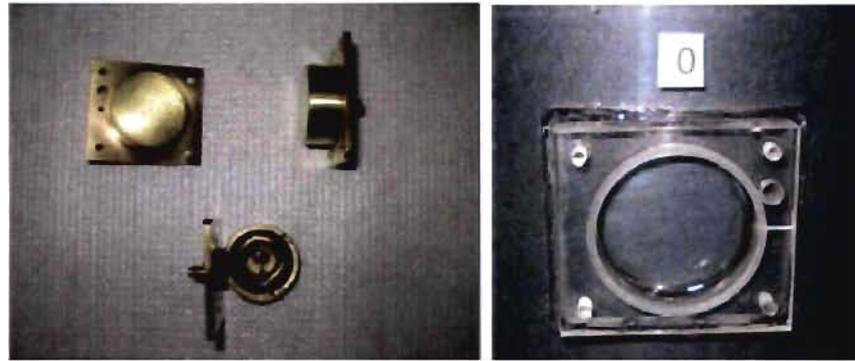
Fig. 2-12 : Senseur piézoélectrique développés par le Groupe PICASSO de l'université de l'Indiana et son emplacement en acrylique servant à soutenir celui-ci sur les parois du détecteur.
