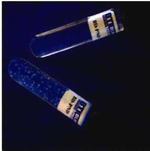
Fig. 2-2 : Dosimètre à neutron fabriqué par Bubble Technology Industry (BTI) montrant deux exemplaires avant et après l'irradiation. La figure est prise de [7].
