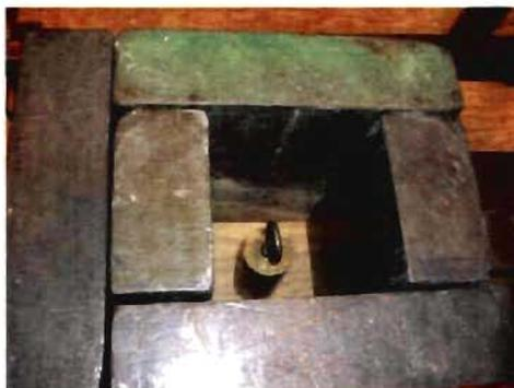
Fig. 5-1 : Source d'AcBe dans le blindage de plomb ouvert.
