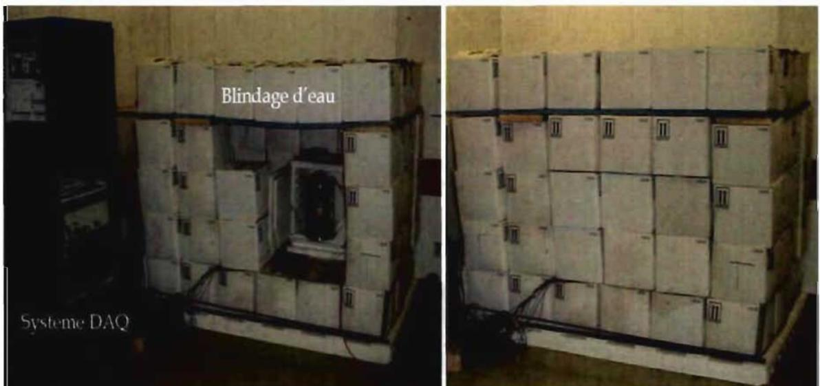
Fig. 5-7 : Montage pour les mesures de bruit de fond avec à droite le blindage d'eau fermé.
