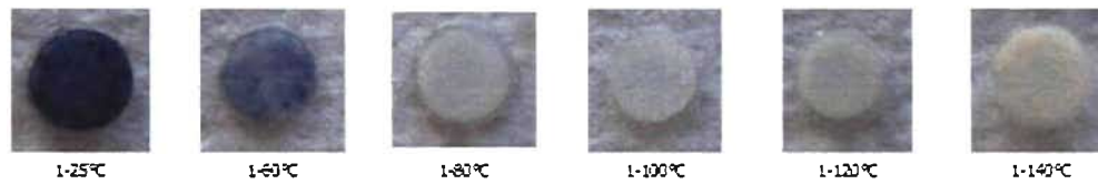
Figure 55. Test qualitatif d'activité après 20 minutes entre le PPD (2 mM) et la laccase immobilisée par microencapsulation sur des formettes séchées à différentes températures entre 25°C et 140°C.
