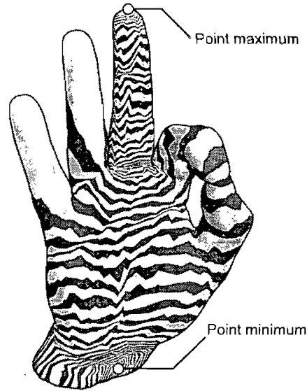
FIGURE 5.5 – La fonction de Morse de Ni et al. évolue entre un point minimum et un point maximum ; elle ne crée pas de points critiques artificiels.
