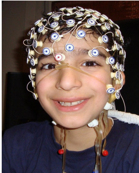
Figure 5. Un enfant de neuf ans portant le bonnet de Geodesic Sensor Net à 128 électrodes d'Ag-AgCl.
