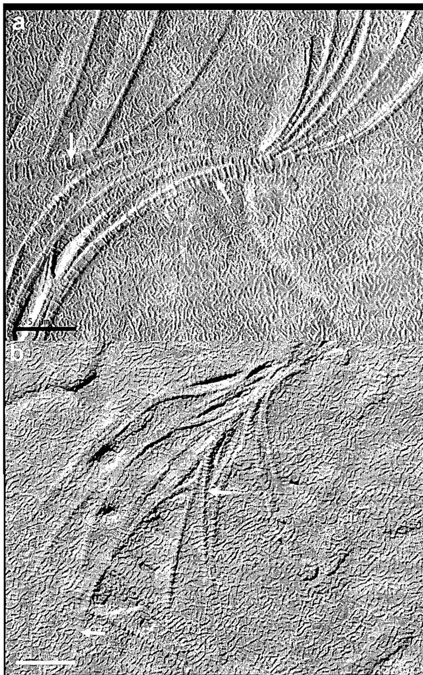
**Figure 8.8 :** Images TEM de films de PDLA de  $110\,000\text{ g.mol}^{-1}$  de (a) 15 ou (b) 30 nm, cristallisés durant 24 h à (a) 140, (b) 155 °C, puis décorés au PE et ombrés par un mélange de carbone et de platine. Les barres d'échelle font  $0.5\ \mu\text{m}$ .
