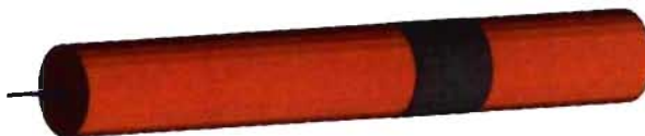
Figure 3.1 – Géométrie simplifiée de la simulation de l'expérience faite au CERF (faisceau hadronique mixte). Le matériau correspondant au PIXEL et au FLEX est enroulé autour de la cible de cuivre pour accroître la statistique de simulation.
