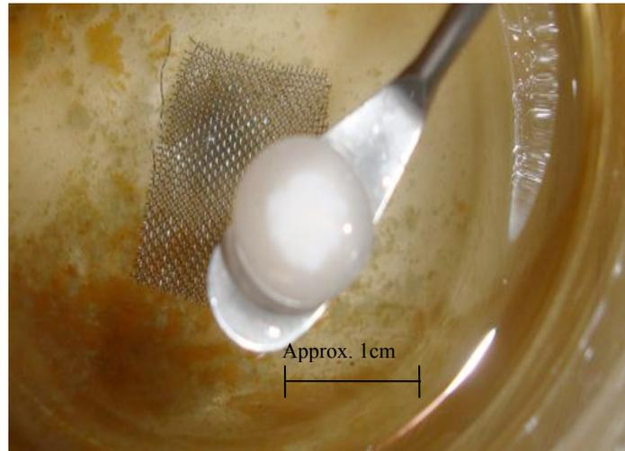
Figure 5.54: Comprimés à base de HPMC contenant 20% du naproxène de sodium comme exemple représentative de comprimés à la fin de la libération du PA laissant une couche de gel transparente.
