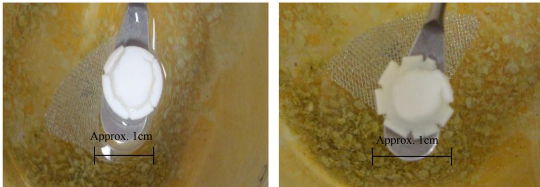
Figure 5.59: a et b: Comprimés à base de SA,G-2.7 contenant 20% du naproxène acide comme exemple représentative de comprimés présentant des fissures multiples à leur surface supérieure et inférieure.
