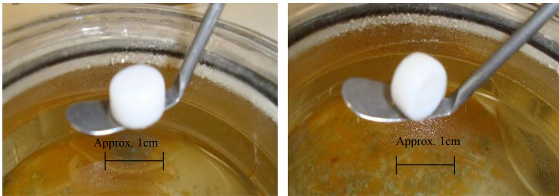
Figure 5.53. a et b: Comprimés à base de HPMC contenant 20% du naproxène de sodium comme exemple représentative comprimés de HPMC gonflés formant une couche de gel.
