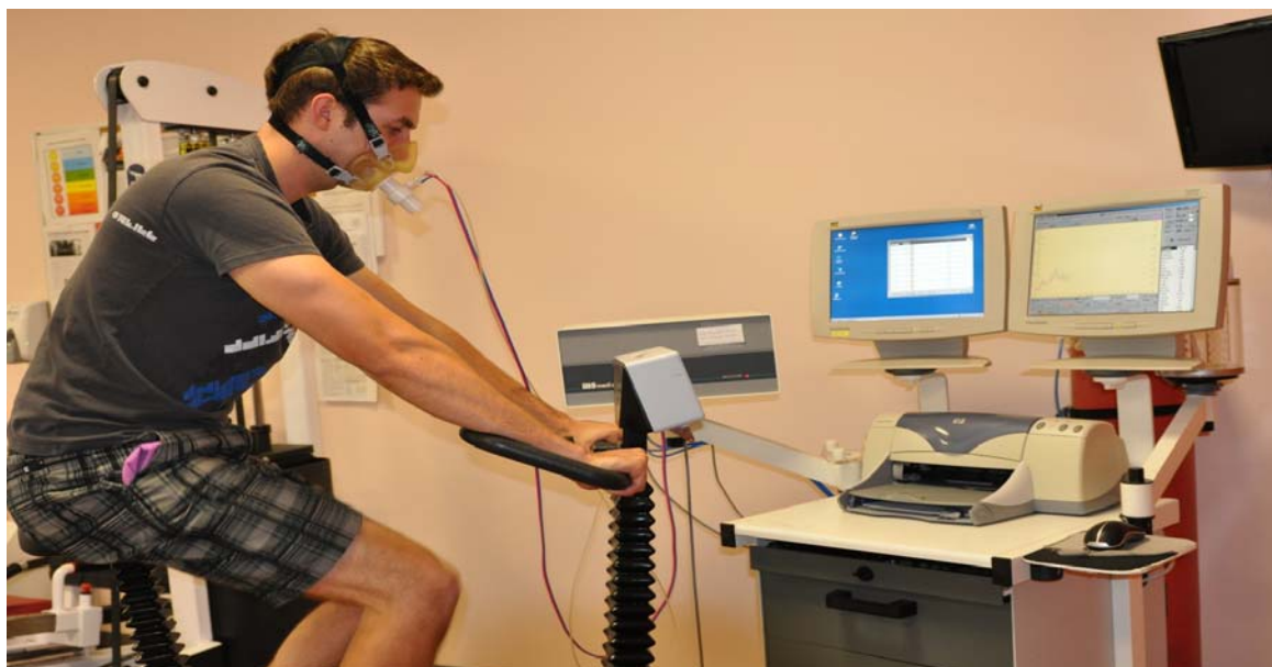
Figure 2. Mesure de la dépense énergétique à l'effort sur ergocycle avec calorimétrie indirecte (Photo IRCM : Annexe 1)
