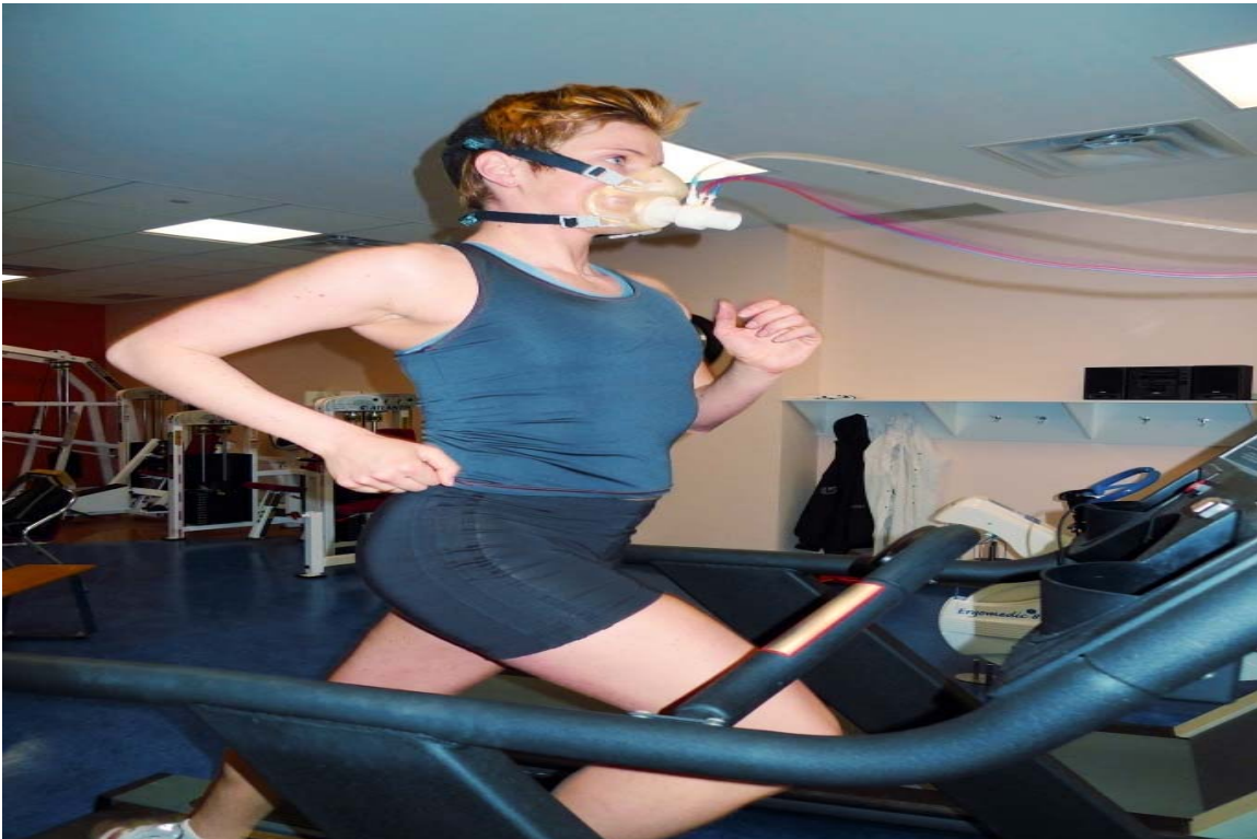
Figure 3. Mesure de la dépense énergétique à l'effort au tapis avec calorimétrie indirecte (Photo IRCM : Annexe 1)
