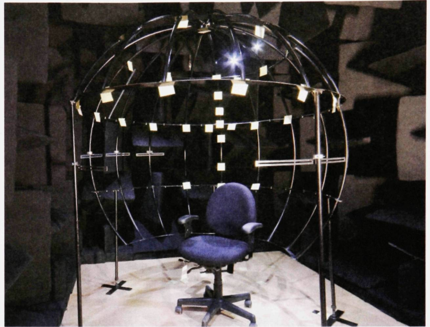
Cette salle acoustique du BRAMS sert à étudier la perception auditive dans un environnement sonore complexe. Équipée de 80 hautparleurs, elle peut simuler tout autant le son d'une salle de concert que le bruit de la rue.
