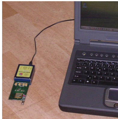
Figure 5.1 – Un détecteur MPX branché à un ordinateur portable par un câble USB.
