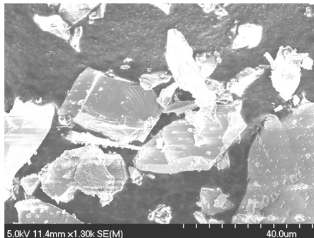
Figure II-10: Image MEB de la surface des particules de \text{LiFePO}_4 . Image réalisée par la détection des électrons secondaires
