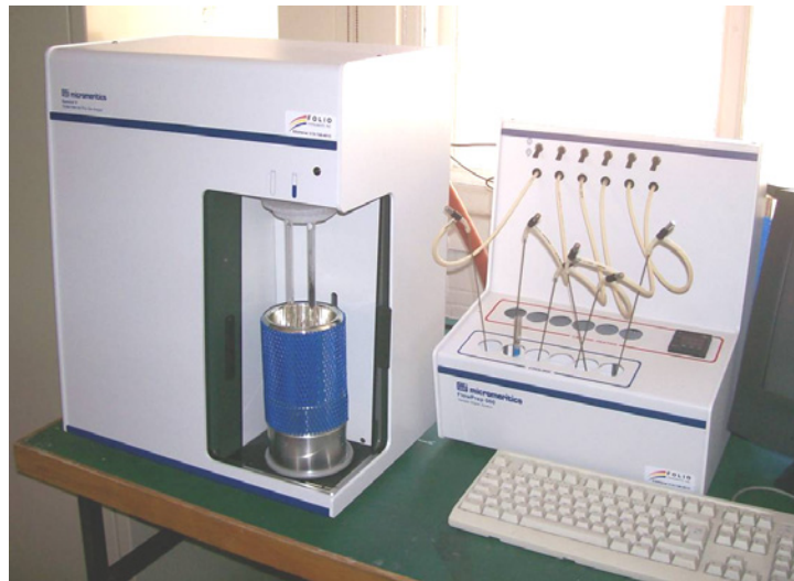
Figure II-13: Appareil de mesure de surface BET
