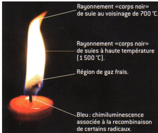
FIGURE 2.2 – Zones d'une flamme laminaire. Source : [Boy06].
