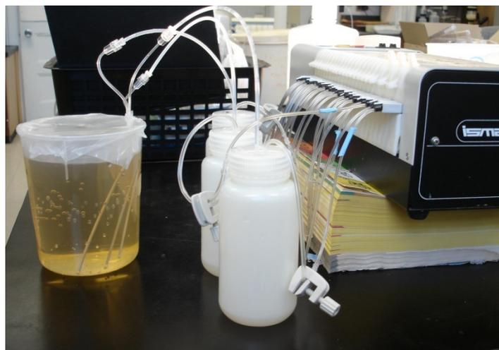
Figure 2.4. Échantillonnage en continu par microlysismétrie d'une solution initiale dont on connaît les concentrations en métaux trace.
