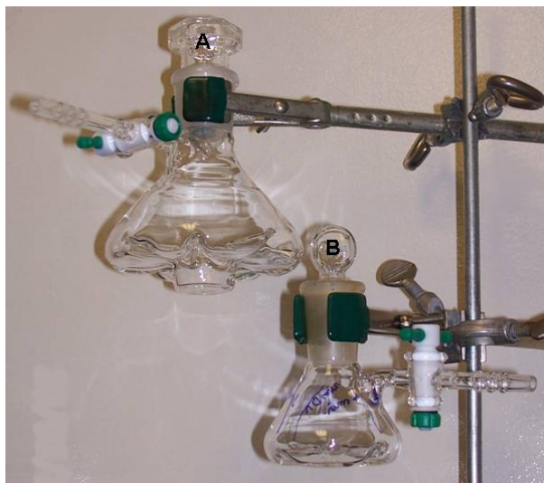
Figure 3.8. Réacteurs de verre utilisés pour la réaction de greffage de l'amorceur. Les réacteurs A et B peuvent contenir respectivement 8 surfaces et 4 surfaces au maximum.
