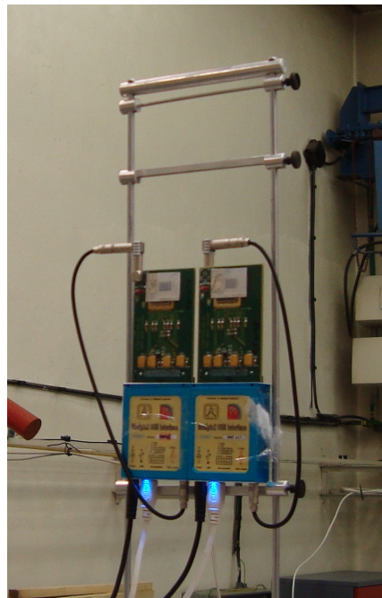
Figure 5.1 – Expérience avec deux détecteurs ATLAS-MPX de référence au Czech Metrology Institute à Prague. Les sources radioactives sont placées en face des détecteurs et ne sont pas présentes dans la photographie par des raisons de sécurité.
