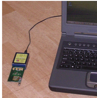
Figure 2.4 – Un détecteur Medipix2-USB connecté à un ordinateur portable par un câble USB qui peut fournir un voltage au détecteur jusqu'à 100V.
