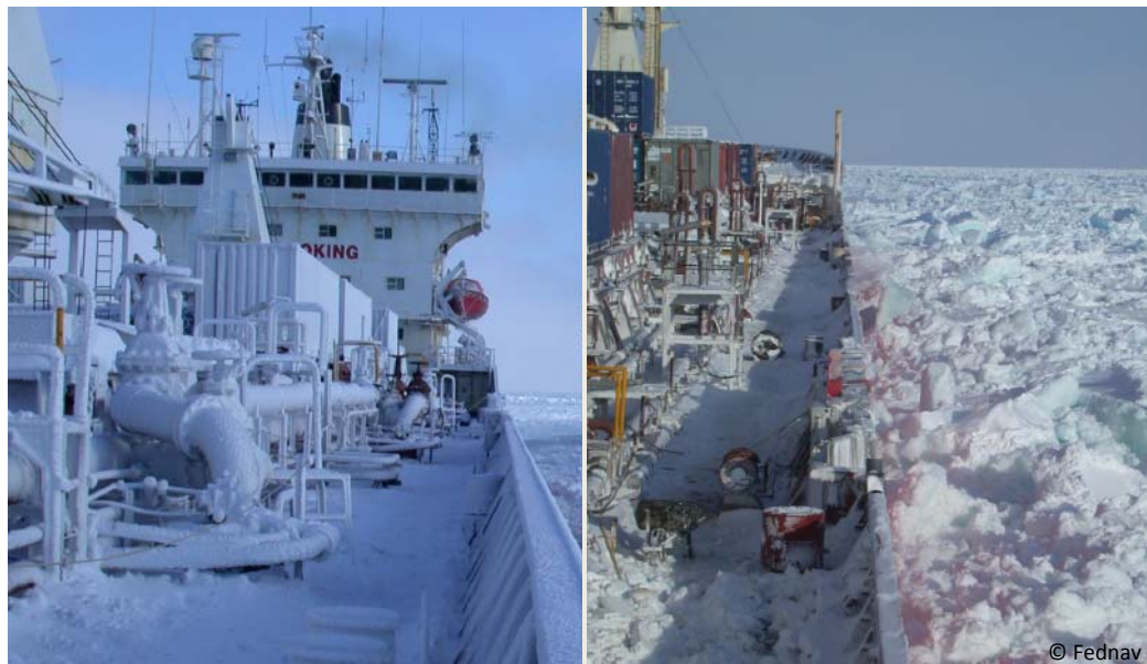
Figure 17. Accrétion de glace à bord des navires en milieu arctique.
