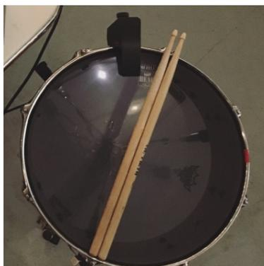
Figure 4 Caisse claire munie d'une peau mesh et d'un capteur Sensory Percussion.
