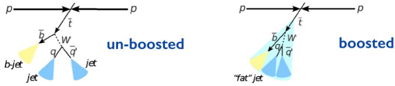
Fig. 1.9. Comparaison entre un jet non boosté et un jet boosté dans un collisionneur de particules. Dans ce cas particulier, la collision initiale entre deux protons produit un quark top. À gauche, le top est trop peu énergétique et les jets ultimement créés sont trop éparés (jet non boosté). À droite, le top est suffisamment énergétique pour pouvoir reconstruire tous les jets en un seul grand jet boosté [119].
