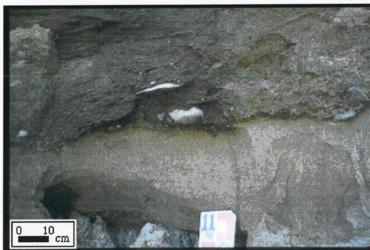
Figure 4.7: Till de chevauchement à matrice sableuse, compact, légèrement fissile à la base et contenant des cailloux subangulaires polis et striés, surmontant un sable moyen massif, compact et sans déformation glacitectonique apparente, dans une excavation située au sud de Bury (site LP-418, Appendice 2).
