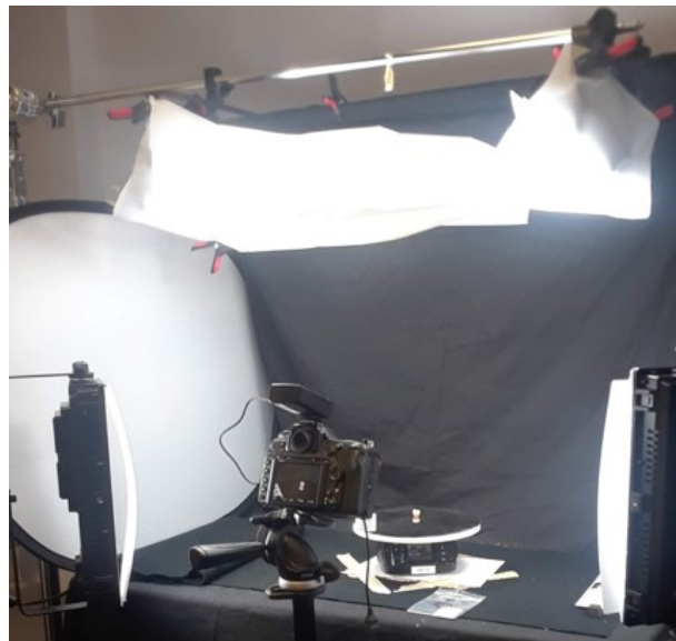
Figure 20. Laboratoire photographique pour la numérisation de l'échantillon dentaire à l'Anthropolab3D (photo : Jade Parent 2020).
