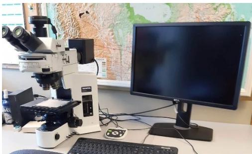
Figure 13. Microscope métallographique de marque Olympus, modèle BX-51 (Crédit photo : Jessica Labonté).
