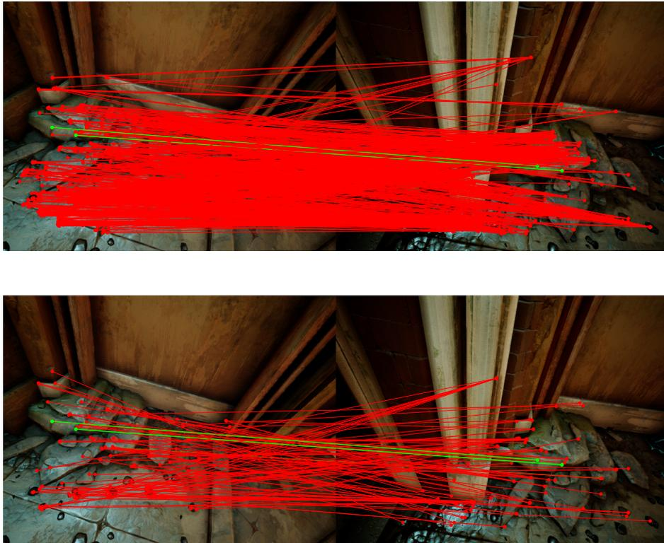
FIGURE 6.61 – Résultat qualitatif de la mise en correspondance entre les points saillants ORB de deux images non-consécutives réalisée avec les descripteurs fournis par le réseau non-entraîné R0, et les descripteurs ORB. Les lignes vertes représentent des mises en correspondance correctes. Les lignes rouges représentent les mises en correspondance incorrectes. Haut : R0. Bas : ORB.
