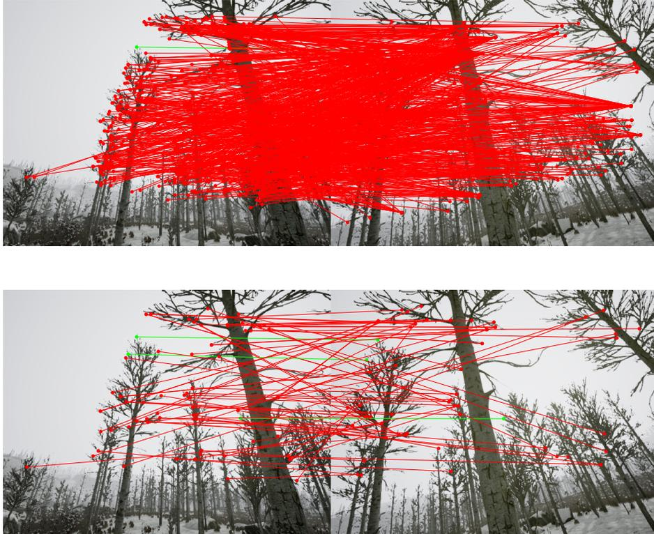
FIGURE A.47 – Résultat qualitatif de la mise en correspondance entre les points saillants ORB de deux images non-consécutives réalisée avec les descripteurs fournis par le réseau non-entraîné R0, et les descripteurs ORB. Les lignes vertes représentent des mises en correspondance correctes. Les lignes rouges représentent les mises en correspondance incorrectes. Haut : R0. Bas : ORB.
