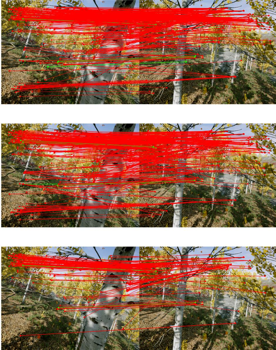
FIGURE 6.49 – Résultat qualitatif de la mise en correspondance entre les points saillants ORB de deux images non-consécutives réalisée avec les descripteurs fournis par les réseaux non-augmentés. Les lignes vertes représentent des mises en correspondance correctes. Les lignes rouges représentent les mises en correspondance incorrectes. Haut : R1. Milieu : R2. Bas : R3.
