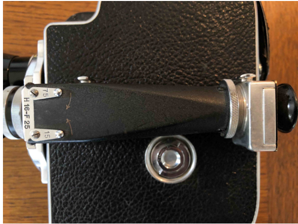
Viseur clair trifocal de la Bolex H16.
