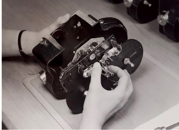
Montage de la platine et du mécanisme dans le bâti de la caméra H16. Voir la fiche.
