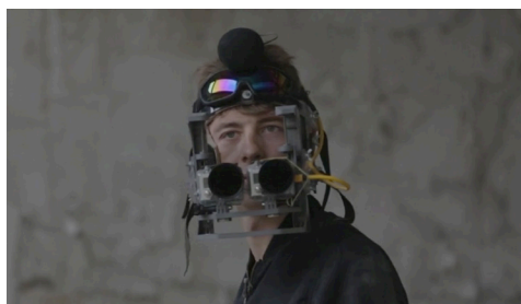
Paire de caméras d'action GoPro utilisée pour tourner Hardcore Henry . Voir la fiche .
