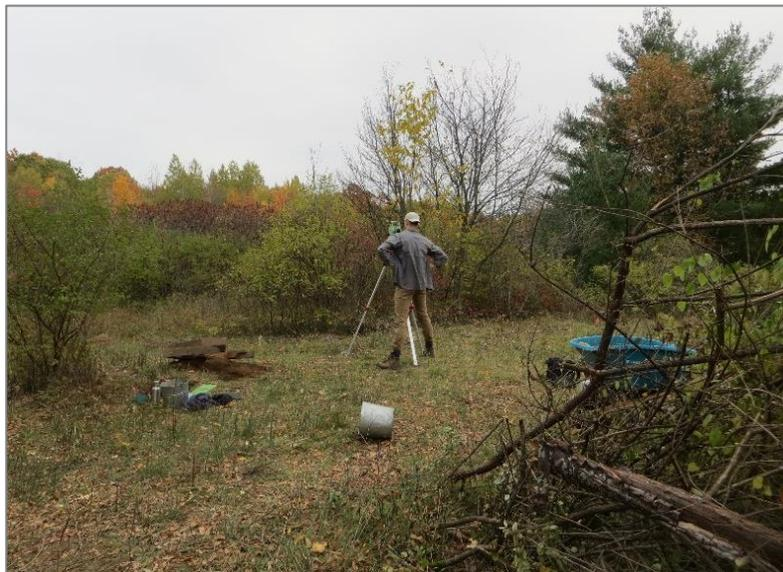
*Figure 5 : Relevé des sondages au tachéomètre sur le site Isings*
