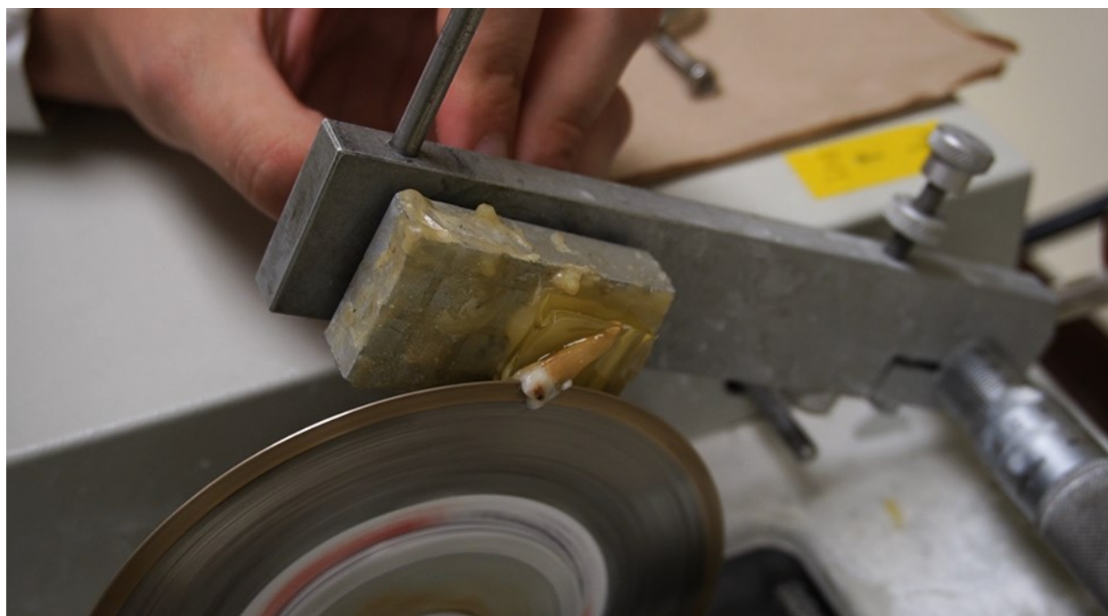
Figure 20. Photo montrant une coupe longitudinale d'une prémolaire (buccal à lingual) avec la scie à vitesse lente Buehler Isomet Low Speed Saw . On peut observer que la dent est scellée dans un bloc de résine qui est collé à un bloc de métal vissé à la scie.
