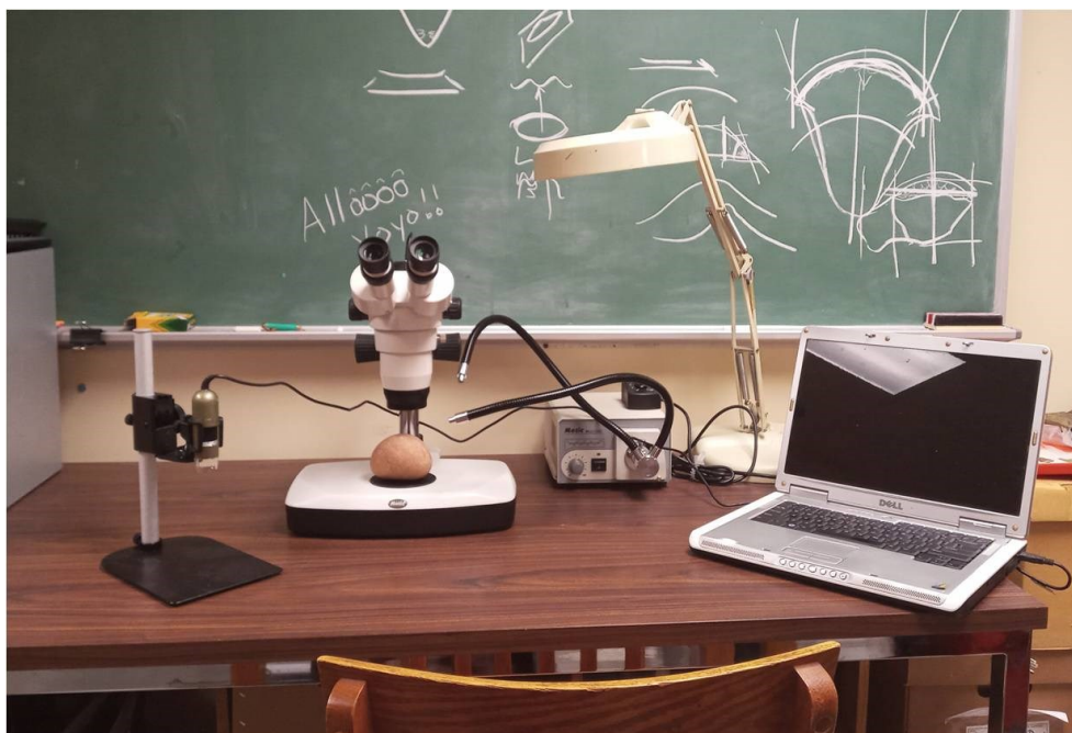
Figure 12 — Station d'analyse, avec le microscope binoculaire Motic agrandissant jusqu'à 100x (au centre), Université de Montréal. Un microscope numérique de marque Dinolite a aussi été utilisé durant l'analyse (à gauche).
