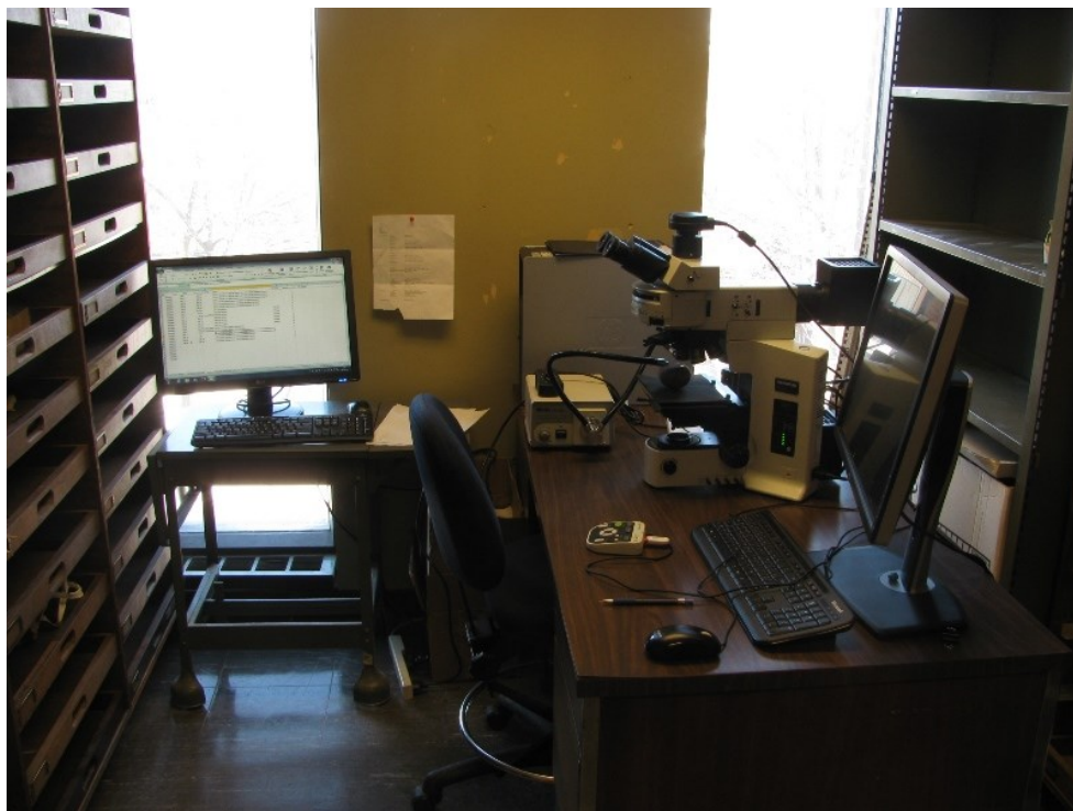
Figure 11 — Station d'analyse, avec le microscope métallographique Olympus agrandissant jusqu'à 200x, Université de Montréal.
