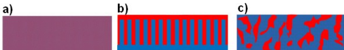
Figure 1-16 : Architectures des couches « donneur » et « accepteur » d'une cellule solaire organique. Reproduite de 24 (open access).
