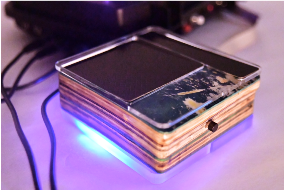
Figure 4. – Interface de contrôle connectée au Bela.
