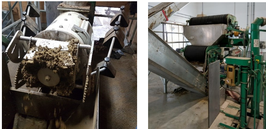
Figure 2. – Séparateurs à pression à vis infinie (gauche) et à rouleaux doubles (droite).
