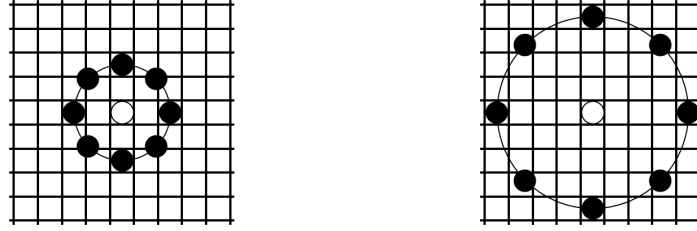
P=8 pixels voisins et le rayon R=2 P=8 pixels voisins et le rayon R=4
