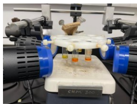
Figure 1.9 : a) lampe à mercure dans un puit d'immersion. Bas : b) ampoules CFL irradiant un milieu réactionnel (image copiée de Hernandez_Augusto_Thèse_2014). c) DELs bleu (450 nm) et mauve (390 nm) irradiant un milieu réactionnel. d) Montage des quatre lampes KESSIL ® (450 mn)
