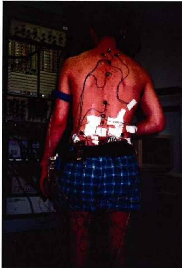
Figure 3.6. Le système d'acquisition OPTOTRAK pour la cinématique et le module ODAU pour l'EMG. Les marqueurs cinématiques et les électrodes des muscles avec les fils et les boîtes de branchement fixées à la taille du sujet sont présentés.
