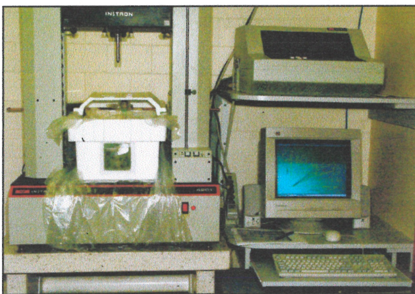
Figure 4.7 : Ensemble du montage, comprenant le bassin de tests, la machine de tests Instron 4201, la console de tests Instron et l'ordinateur servant à l'acquisition des données.
