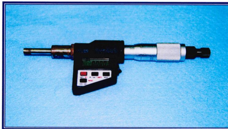
*Figure 3.7: Micromètre de marque Starrett (plage 0 à 25 mm).*
