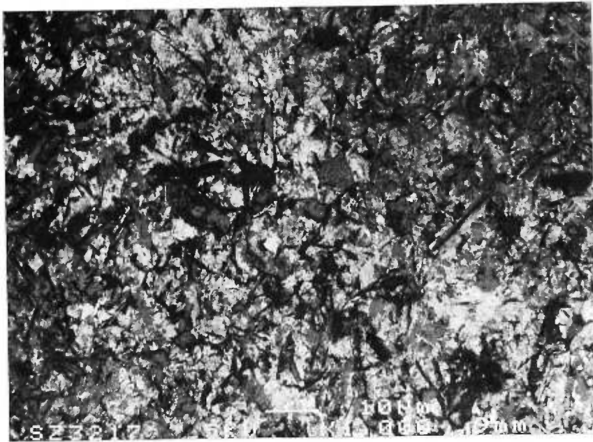
Figure 16b. (Photo 3217 en BEI 1000x) Fracture surtout adhésive entre le métal et la résine. Le métal est pâle et les particules organiques sont sombres (pas évaporées au carbone).
