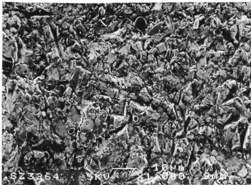
Figure 18a. (Photo 3264 en SEI 1000x) Surface d'échantillon métallique recouverte d'un peu de matériel ayant un poids atomique plus bas.
