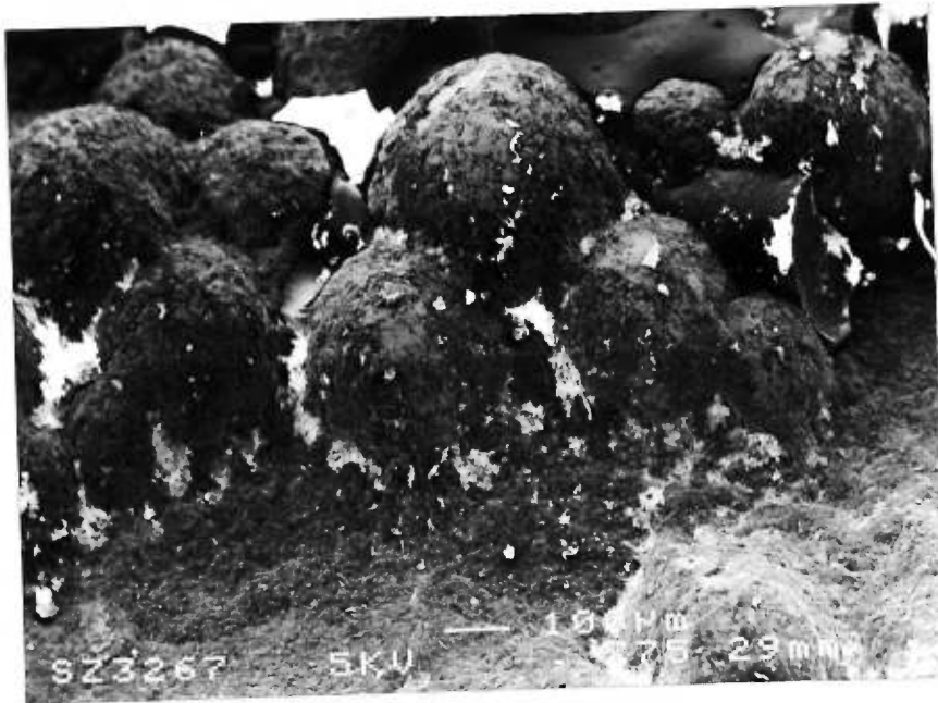
Figure 14f. (Photo 3267 en BEI 75x) même échantillon mais vue oblique. Les billes sont à deux épaisseurs de haut et empilées les unes sur les autres. Ceci augmente inutilement l'épaisseur des organes de rétention. Cette photomicrographie explique également pourquoi on voit des billes de différents diamètres lorsqu'on regarde d'en haut. Le centre de la photomicrographie montre une bille sur la surface métallique qui pourrait avoir une surface rétentive mais en est dépourvue parce que la substance adhésive utilisée, pour la retenir lors de la fabrication du métal, bloque cette région.
