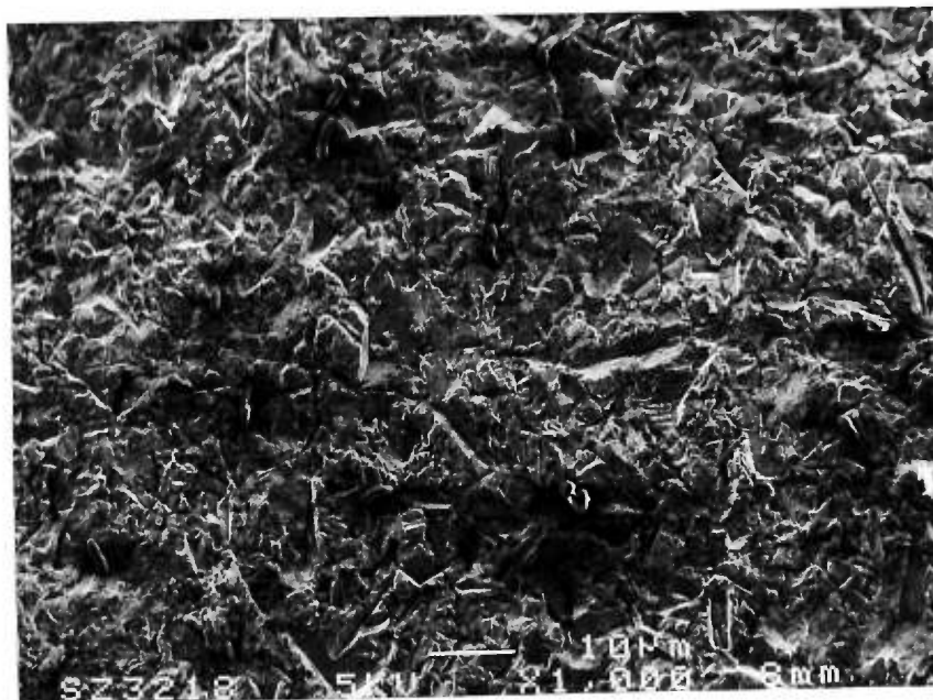
Figure 16c. (Photo 3218 en SEI 1000x) Beaucoup de métal et peu de résine. On voit un petit morceau blanc à l'extrême droite qui est de la résine (pas évaporée au carbone) chargée électriquement.
