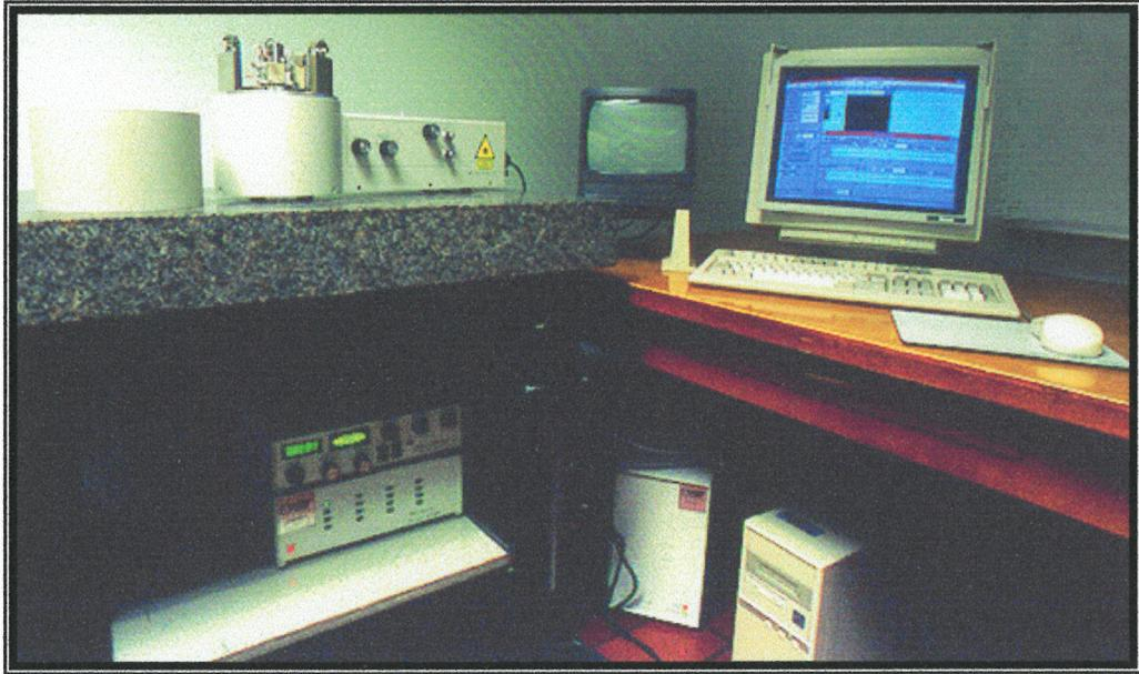
Figure 3.9 : Microscope à force atomique Topometrix TMX 2010.
