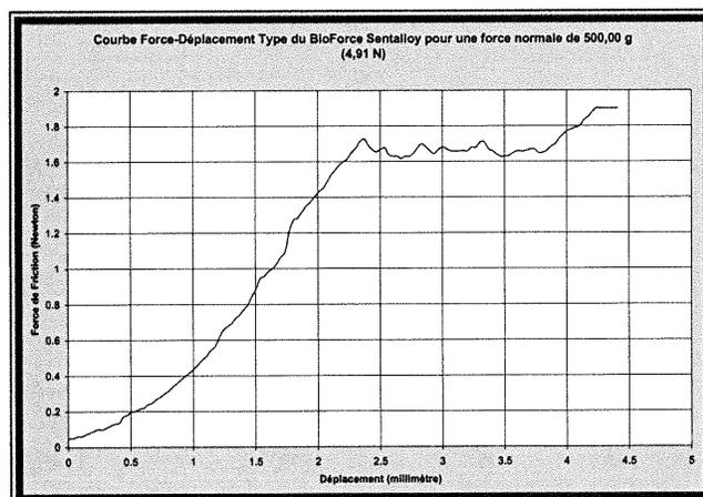
Figure 4.6 : Courbe force-déplacement type du BioForce Sentalloy pour une force normale de 500,00 g (4,91 N).
