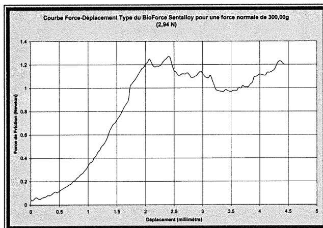
Figure 4.5 : Courbe force-déplacement type du BioForce Sentalloy pour une force normale de 300,00 g (2,94 N).
